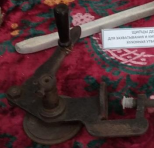
ПРИСПОСОБЛЕНИЕ ДЛЯ ВЫРАВНИВАНИЯ БУ КРЫШЕК ДЛЯ КОНСЕРВИРОВАНИЯ
