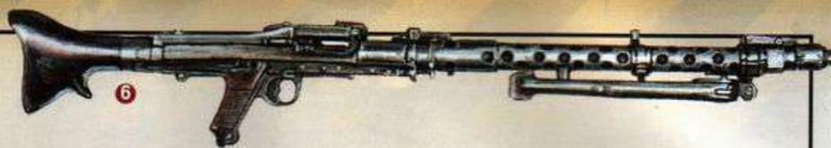
6: Немецкий пулемет MG-34 был достаточно сложным в использовании. Песок, влага и грязь могли стать причиной выхода его из строя, и поэтому необходимо было, чтобы опытный пулеметный расчет постоянно содержал его в чистоте и порядке.
